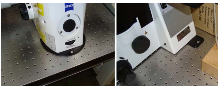
図10 専用金具による除震台への顕微鏡の固定。
