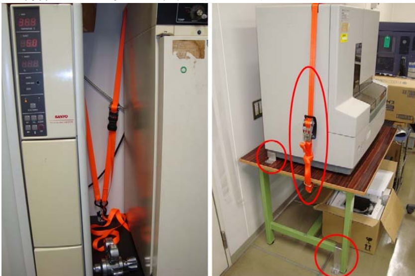
図6 卓上機器に対する荷締めベルトによる固定
