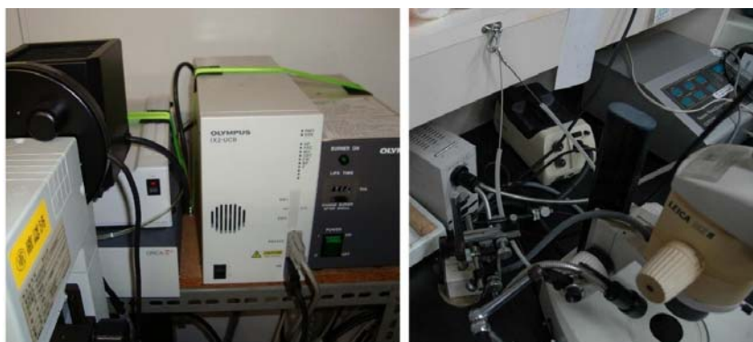
図7 荷締めベルト、底部ブラケットによる次世代シークエンサーの固定
