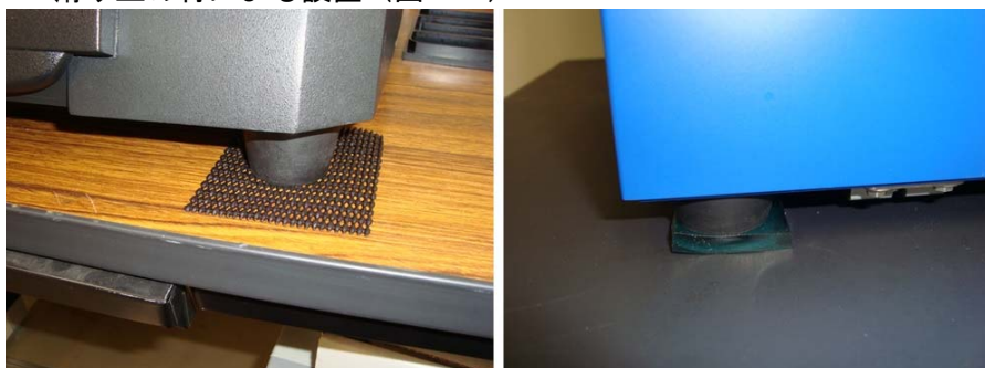
図12 （左）ノンスリップマットによる滑り防止（激しく揺れる船内での研究機器の落下防止にも実績ありとのこと）。（右）シリコンパッドによる振動吸収と滑り防止。
