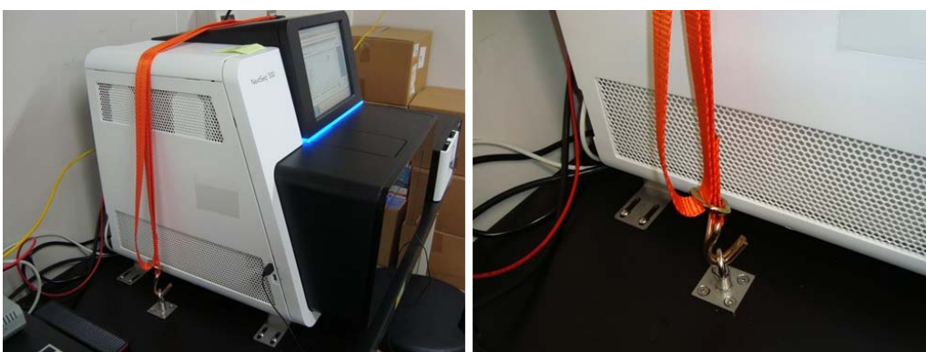
図7 荷締めベルト、底部ブラケットによる次世代シークエンサーの固定
