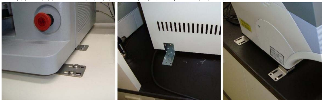
図9 金具による実験台天板への固定
