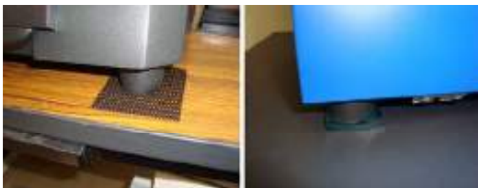
図11 固定具（樹脂製）による顕微鏡類の固定本体、天板への固定は両面粘着材による。
