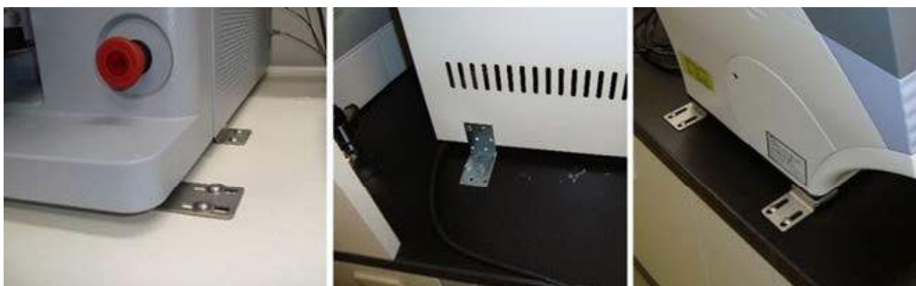
図11 固定具（樹脂製）による顕微鏡類の固定本体、天板への固定は両面粘着材による。
