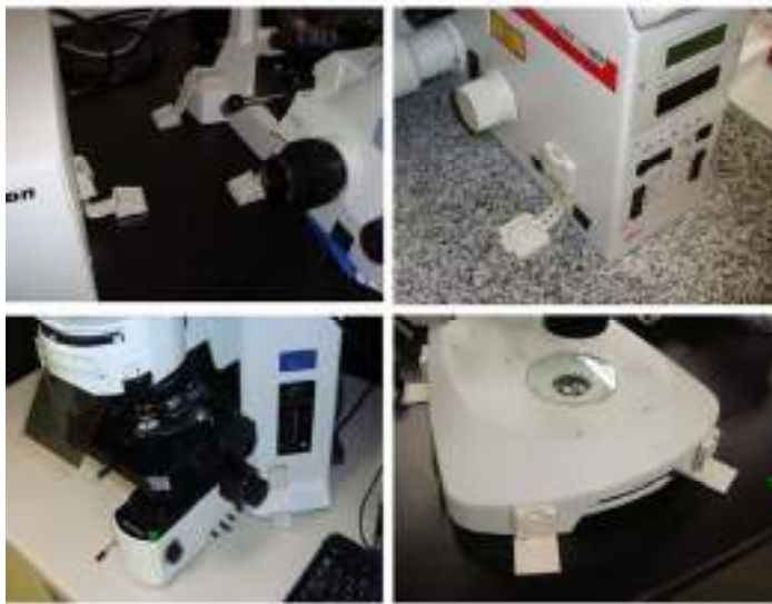
図9 金具による実験台天板への固定 (左) 爪型金具によるFACS脚部の固定。天板への固定は5ミリサイズタッピングネジ。(中) 汎用金具によるインキュベーターの実験台への固定。天板へは4ミリサイズの木ネジ、インキュベーター本体は穴あけの上、M4ボルト&ナットで締結。(右) 特殊金具による次世代シーケンサー脚部拘束。天板への固定は5ミリサイズタッピングネジ。
